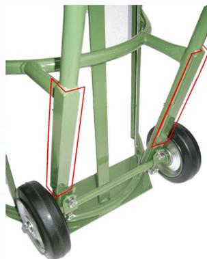
赤枠箇所（外側）に、アングルを溶接して、足部分を補強します。
