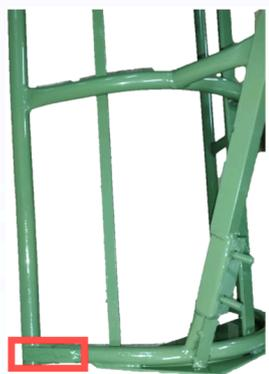
赤枠箇所（外側計2ヶ所）に、フラットバーを溶接して、底パイプ部分を補強します。
